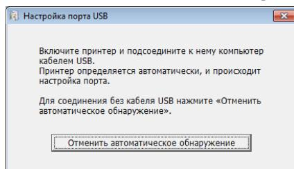
**6****Включите принтер RISO.****7****Подсоедините компьютер к принтеру RISO с помощью кабеля USB (высокоскоростной USB, 3 м или меньше).**
